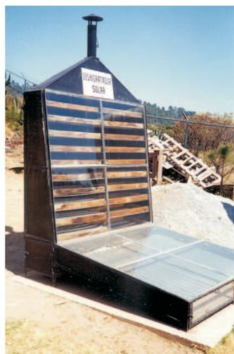
Se recomienda construir los secadores de madera, como se muestra en la figura, ya que los secadores metálicos pueden causar reacciones con los frutos, sobre todo con aquellos que son ácidos, incluso pueden ser contaminados por el metal, con riesgos para la salud.
